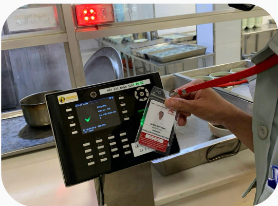
Mô hình kiểm soát tại nhà ăn: Thiết bị đọc thẻ AbriVISION + Đèn Led (Xanh /đỏ).
